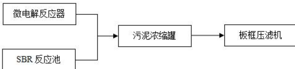
图 3 污泥处理系统工艺流程图
